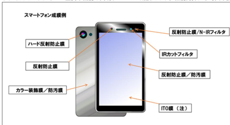
（注）ITOとは透明かつ導電性を有する酸化インジウムスズの英語名であるIndium Tin Oxideの頭文字から取った名前であり、この薄膜をITO膜と呼びます。スマートフォンの場合、透明導電性を活かして薄型の透明電極として使用しています。
